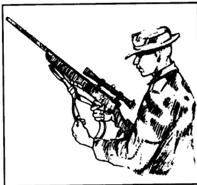
Fig.2-3 Aggiustamento della lunghezza della cinghia
